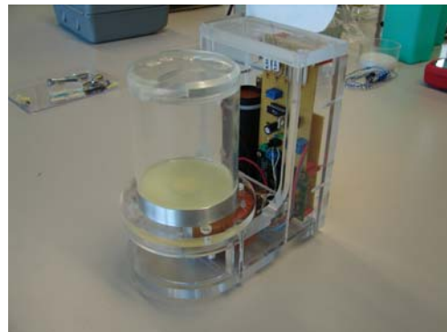
Abb: Elektrischer Seifenspender des HSG-IMAT mit Mehrweg-Pumpelement
